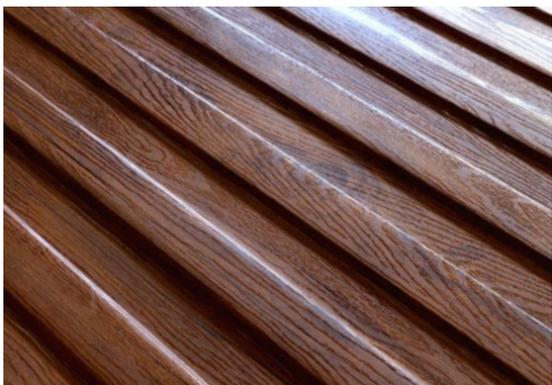
**PRINTECH.** Это инновационное покрытие стали на основе полиэстера. Преимущество покрытия Printech заключается в необычности его рисунков — расцветка под дерево и натуральный камень придают изделиям неповторимый вид. Гарантия 15 лет. Толщина покрытия 30 мкм. Цинкование Zn 200.
