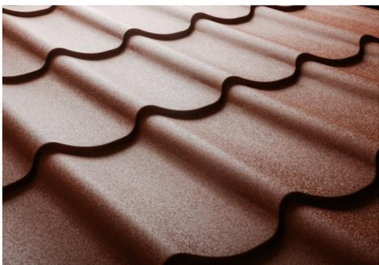
**МАТТ.** Матовое покрытие имеет шероховатую текстурированную поверхность. Такое покрытие более устойчиво к повреждениям и царапинам. За счет шероховатой поверхности имеет повышенные эстетические данные по сравнению с глянцевыми покрытиями. Гарантия 15 лет. Толщина покрытия 35 мкм. Цинкование Zn 140.
